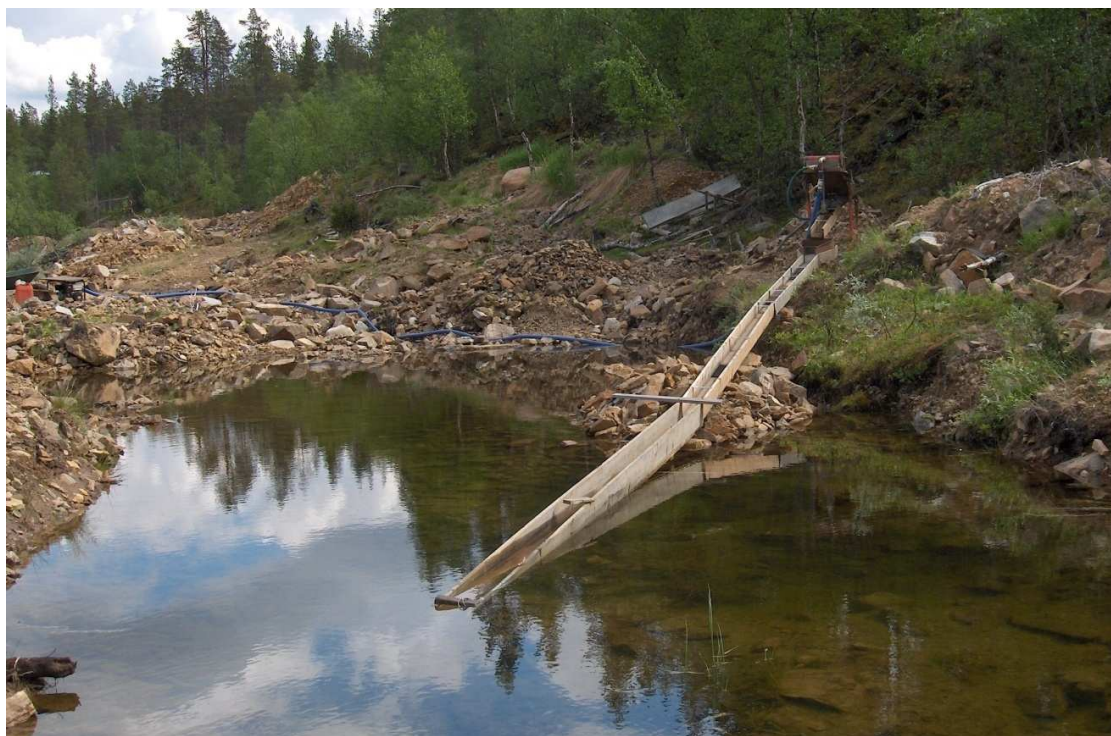
Kuva 1. Lapiokaivajan kaivupaikka. Ränniin juoksutetaan vettä joko pumpun avulla tai luonnollista virtaa hyväksikäyttäen. Samalla rännin yläosaan lapioidaan kultapitoista
