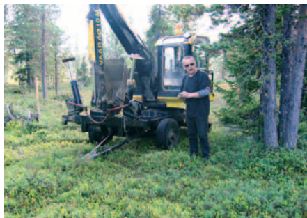
Kuva 7. Raskasmineraalinäytteenottoon käy- tettiin Terho Ukkolan minikaivuria.
