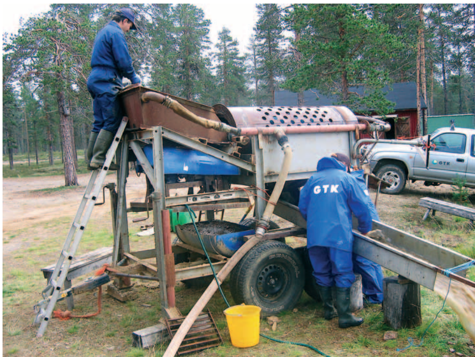
Kuva 8. Raskasmineraalinäytteiden rikastus rumpuseulalla ja rännillä.
