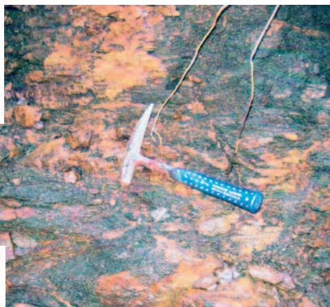
Kuva 6. Kulta- ja kuparipitoinen kvartsisuo-nisto muodostaa breksiamaisen rakenteen emäksisessä vulkaniitissa.
