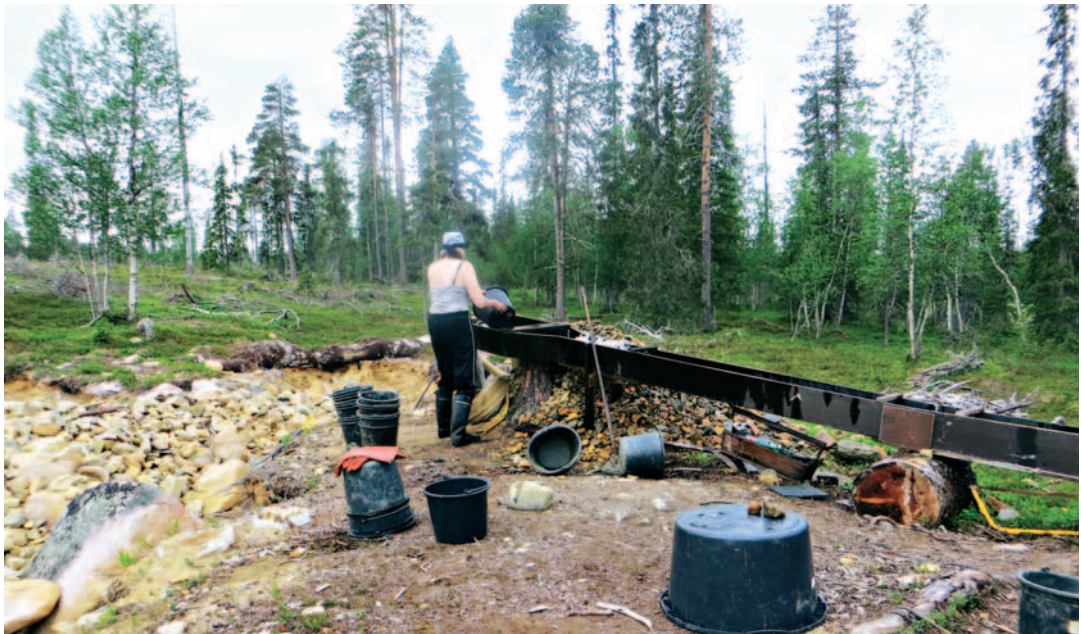
Kaivaminen on kovaa työtä, mutta hiljaa kiirehtien homma luonnistuu. Kuvassa kaadetaan 10 litran sangosta veden eroteltavaksi. Taustalla näkyy kaivettu alue, jonne on alettu kasaamaan kiviä. Nurin oleva musta palju on paikalla vaskaamista varten. Kaikkien selkä ei suosi lähteen rannalla vaskaamista (Kuva Eelis Pulkkinen).
