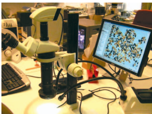
Optinen makroskooppi varustettuna digitaalikameralla näytteiden kuvausta varten. Kuva Kari Kojonen
